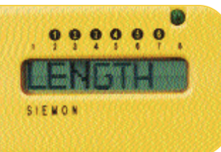
ケーブル長の測定
